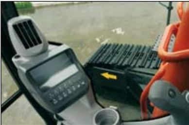
Der in der Kabine angeordnete LCD-Farbmonitor zeigt die Kühlmitteltemperatur, den Kraftstoffstand sowie Wartungsdaten an. Auch ist eine Einstellung des Anbaugeräts durch einen einzigen Tastendruck möglich. Die Anzeige kann auch auf Tages- oder Nachtschicht eingestellt werden.
