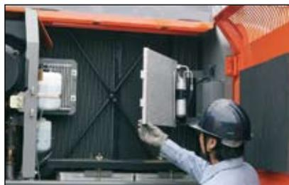
Anstatt wie bei der herkömmlichen Reihenanordnung sind Ölkühler, Wasserkühler und Zwischenkühler parallel angeordnet. Diese Parallelanordnung lässt sich wesentlich einfacher um den Motor herum reinigen. Der Klimaanlagekondensator lässt sich klappen, so dass die Reinigung des Kondensators und des dahinter befindlichen Wasserkühlers vereinfacht wird.
