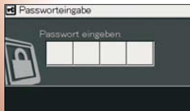
Bei jedem Start des Motors ist aufgrund der elektronischen Wegfahrsperrung die Eingabe eines Verschlüsselungscodes im Multifunktionsmonitor erforderlich, um Diebstahl und Vandalismus zu verhindern.
