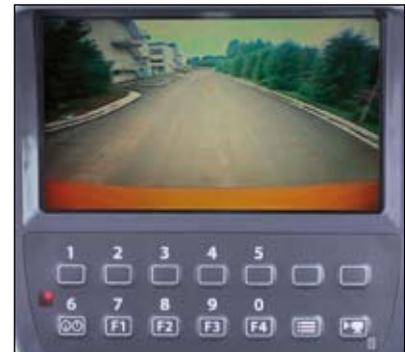
Der breite LCD-Farbmonitor ermöglicht auch die Sicht in Richtung Maschinenheck. Der Hauptvorteil besteht in der erhöhten Sicherheit beim Schwenken und Fahren.
